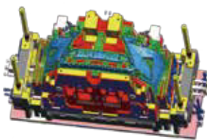
図② 三次元設計された金型 (可動型)
